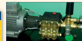
Pompa ad alta pressione a pistoni ceramici
